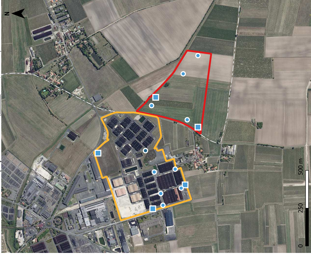
État de la DECI existante et projetée sur le site (source : IGN, ORECO)
